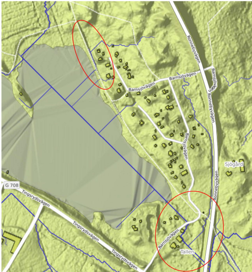
Figur 15 Naturliga rinnvägar (blå linjer) och instängda områden (röda markeringar) vid nederbörd, enligt resultat Scalgoanalys.
